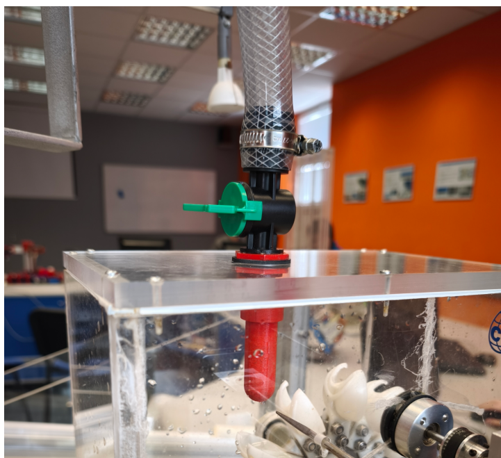
Obrázek 8: Zkompletovaná tryska na laboratorním modelu
