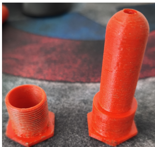
Obrázek 7: Finální tryska se závitovou vložkou
